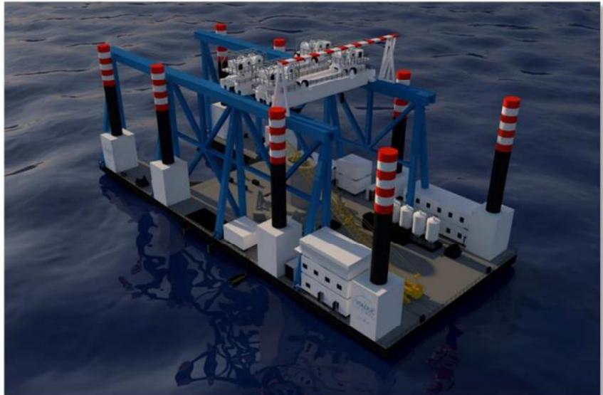
Ce navire sur-mesure permettra de transporter en mer et de placer en précision les futurs éléments des piles et voussoirs spéciaux du tablier :
