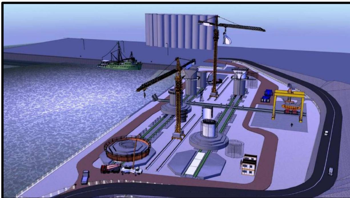
L'aire de préfabrication des piles se compose de **quatre lignes de production** (2 lignes de production pour les embases et 2 lignes de production pour les têtes de pile), **d'une aire d'assemblage des méga voussoirs sur piles** et d'un **nouveau quai d'embarquement** de 100 mètres de long.
